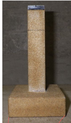
模型試験体 (アルミ製) 表面砂貼付
