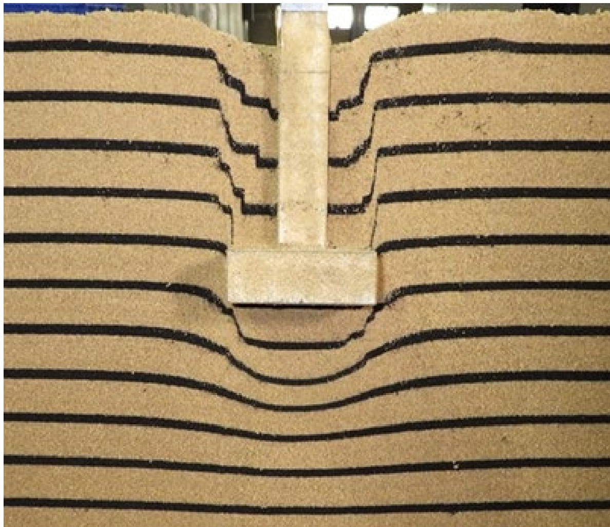
遠心載荷実験 ( U_z=1200\text{mm}, U_z/B=0.50 )
