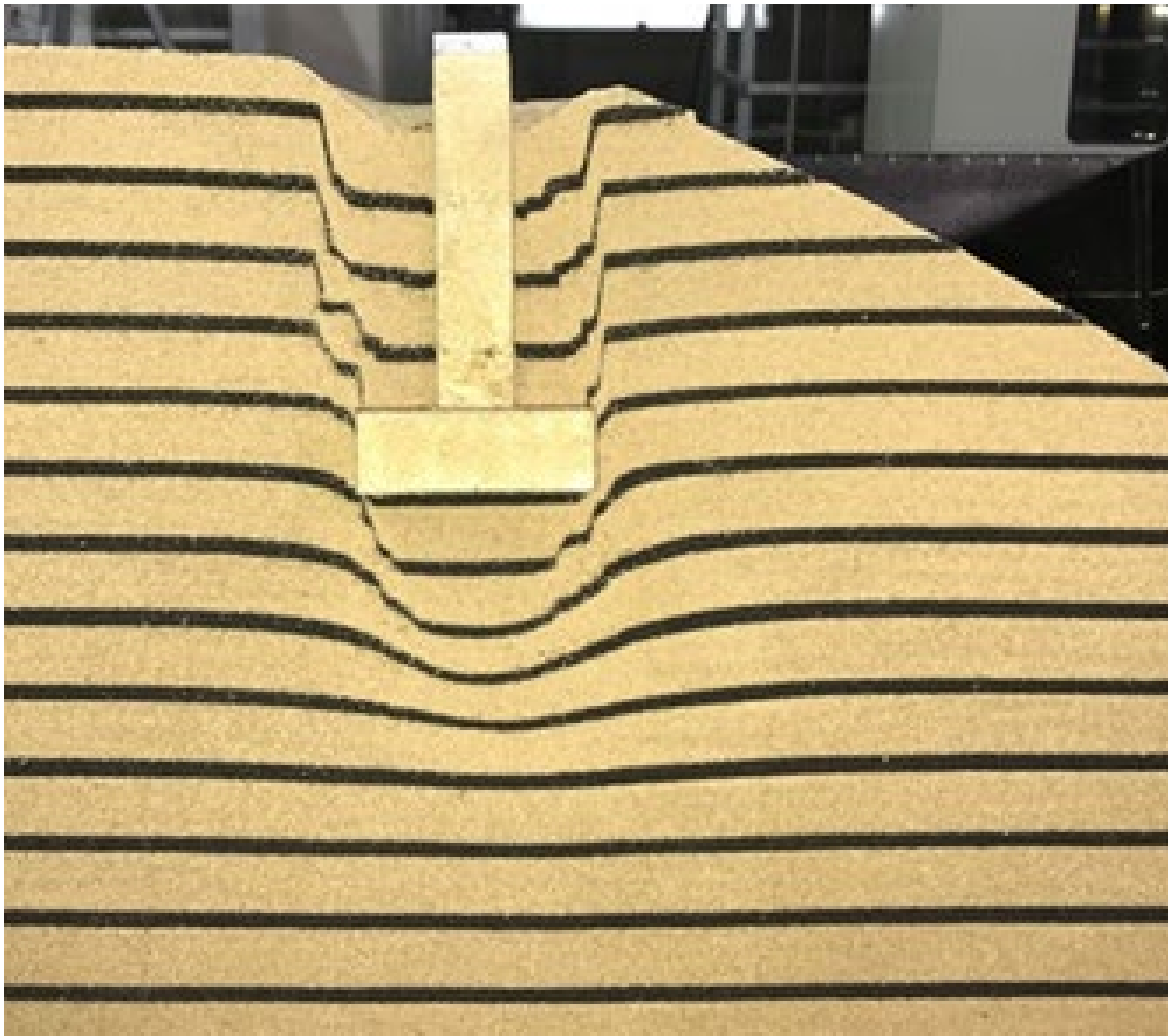
遠心載荷実験 (Uz=1200mm,Uz/B=0.50)
