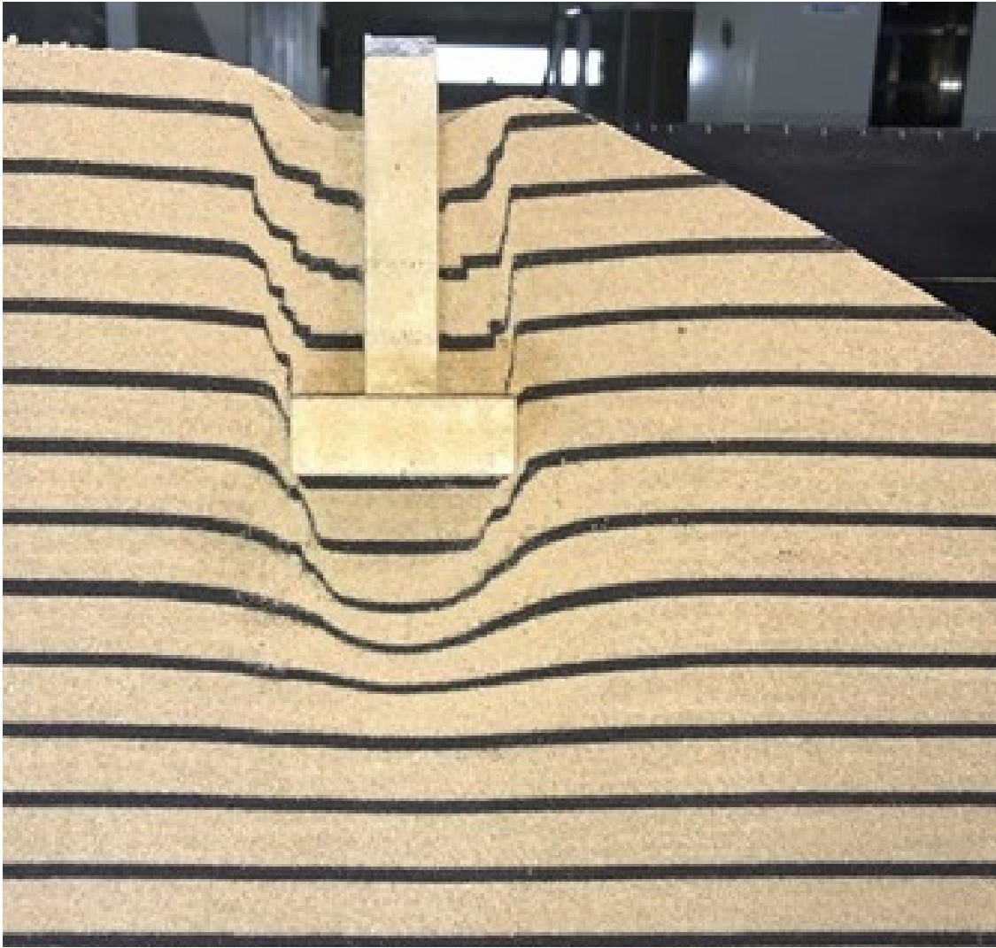
遠心載荷実験 (Uz=1226mm,Uz/B=0.51)
